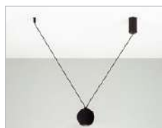
Чаша Ø50×95 мм, длина регулируемого подвеса 1500 мм
