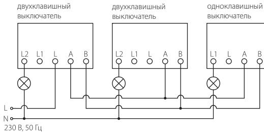
Перекрестная система с использованием одноклавишного механизма
