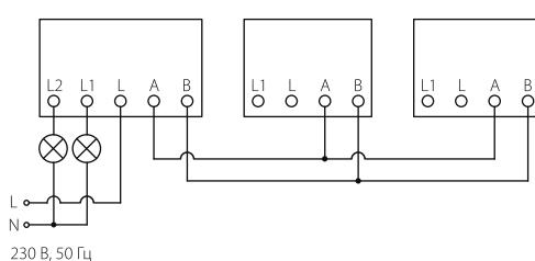
Проходная система с использованием одноклавишного и двухклавишного механизма
