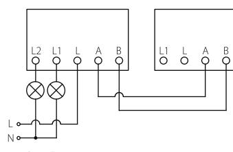
Перекрестная система с использованием одноклавишного механизма
