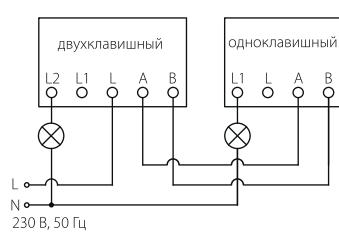
Перекрестная система с использованием двухклавишного механизма
