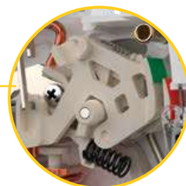
Механизм расцепителя Скорость замыкания контактов не зависит от скорости движения рычага взвода
